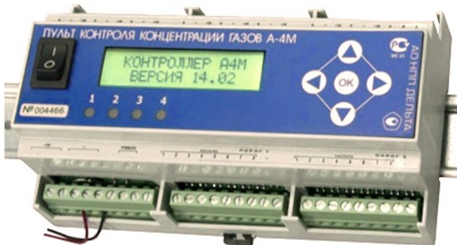
Рисунок 3. Внешний вид и габаритные размеры пульта контроля А-4М
